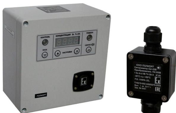
Сигнализатор «Орт-02В» предназначен для непрерывного автоматического контроля и выдачи световой и звуковой сигнализации о превышении установленных значений до взрывоопасных концентраций горючих газов в воздухе.
